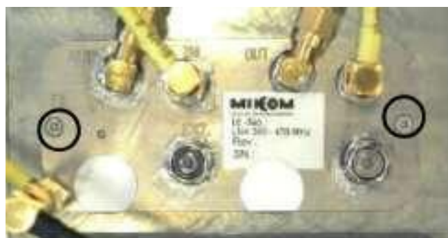
Рис. 8-3 Замена предварительного усилителя
