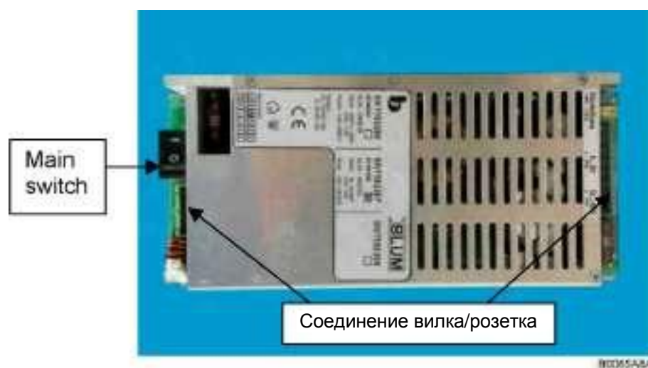
Рис. 8-9 Замена блока питания
