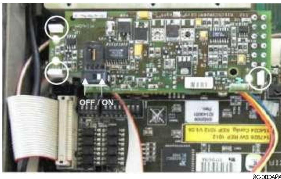
Рис. 8-10 Съем модуля резервного источника электрической энергии
