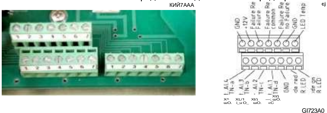
Рис. 3-13 Расположение клемм подключения наружного сигнального устройства
