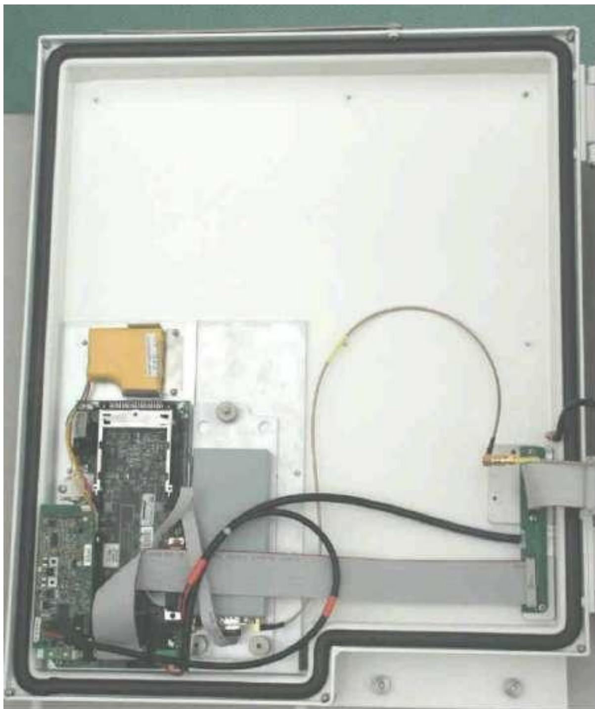
Рис. 9-3 Вид сверху открытой двери шкафа с модемом MO4000* * эта модель более не устанавливается; она заменена на MC35
