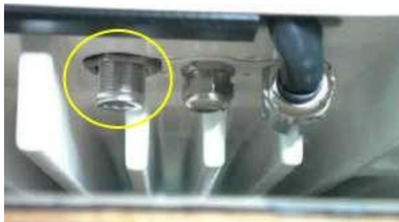
Рис. 3-12 Розетка наружной антенны модема
